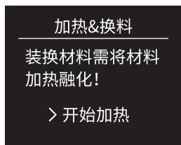
2.此时挤出机会自动从初始位置移动到平台中央，并开始加热挤出机（如图），等待喷头温度达到设定温度（默认205°C）后屏幕提示“现在请换装材料”。
