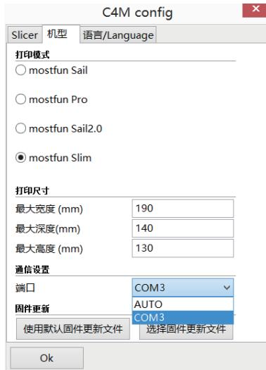
如果驱动安装好后，点击端口中会自动弹出对应的口号，如果你不确定该端口号是否正确，可以右键点击电脑桌面的“计算机”，随后选择“属性”——“设备管理器”，然后查找对应的通信端口，如右图：
