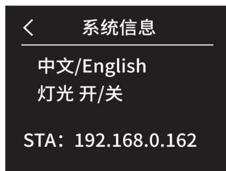
6.然后将设备(电脑或手机)连接在与 X 连接的同一热点中，打开浏览器，输入地址(如：192.168.0.162)登陆进入控制后台。
