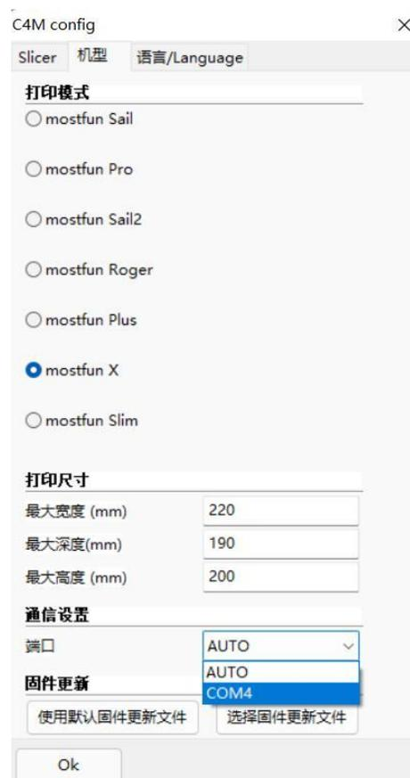
如果驱动安装好后，点击端口中会自动弹出对应的端口号，如果你不确定该端口号是否正确，可以右键点击电脑桌面的“计算机”，随后选择“属性”——“设备管理器”，然后查找对应的通信端口，如下图：
