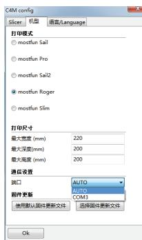
如果驱动安装好后，点击端口中会自动弹出对应的口号，如果你不确定该端口号是否正确，可以右键点击电脑桌面的“计算机”，随后选择“属性”——“设备管理器”，然后查找对应的通信端口，如右图：
