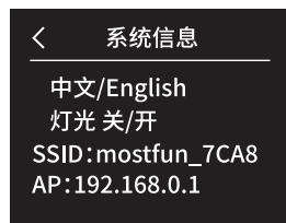
2. 打印机通电后，使用设备(手机或者电脑)，搜索打印机的无线账号(SSID)，如图：
