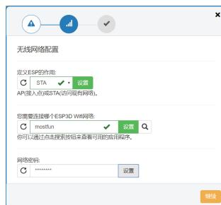
5.重新启动打印机后机器会自动尝试连接该无线网络，连接成功后，在系统信息中，会显示对应STA的IP地址，如图：
