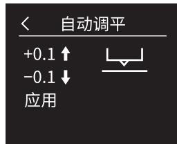
自动校准平台成功后，以后的打印不需要再次进行调平与校准，用户可直接导入模型文件，进行打印操作。
