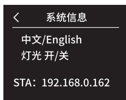
6. 然后将设备(电脑或手机)连接在与Roger连接的同一热点中, 打开浏览器, 输入地址(如: 192.168.0.162) 登陆进入控制后台
