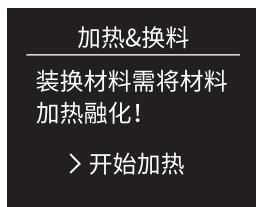
2.此时挤出机会自动从初始位置移动到平台中央，并开始加热挤出机（如图），等待喷头温度达到设定温度（默认210°C）后屏幕提示“现在请换装材料”。
