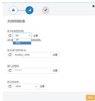
4. 将wifi连接模式设置为STA，随后设置界面会发生变化。点击搜索在wifi列表中选择要接入的网络，填入当前网络密码。
